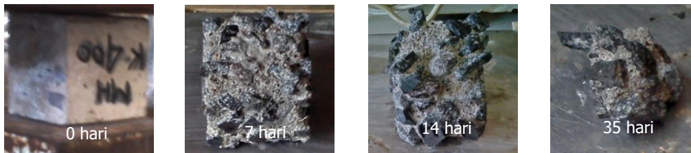
Gambar 5. Kondisi visual beton N30 setelah direndam asam sulfat (H 2 SO 4 ) 5%
