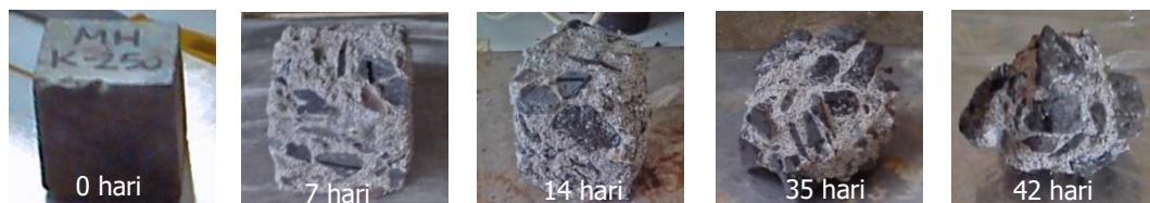
Gambar 3. Kondisi visual beton N20 setelah direndam asam sulfat ( H_2SO_4 ) 5%
